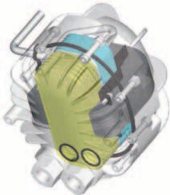
Wärmetauscher **PlusPack** 3-in-1 (zum Patent angemeldet), sind aus festem Aluminium mit freiem Luft-Luft-Wärmetausch und enthalten Verdampfer und Tröpfchenabscheider mit langsamer Strömung sowie integrierten Luftanschlüssen.
