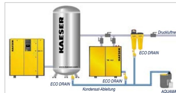
An allen Kondensat-Sammelstellen des Druckluftsystems muss eine zuverlässige Ableitung gewährleistet sein. Dies geschieht am besten durch elektronisch geregelte Kondensatableiter.
