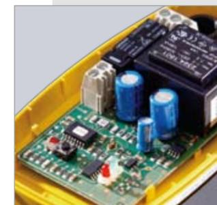
Die intelligente Steuerelektronik steuert das exakte Öffnen und Schließen der Ventilmembran. So wird nur Kondensat abgeleitet und keine Druckluft! Das verhindert Druckluftverluste und spart Energie. Alle Elektronikkomponenten sind spritzwasserdicht (IP 65, ECO DRAIN 30/31: IP54) montiert.
