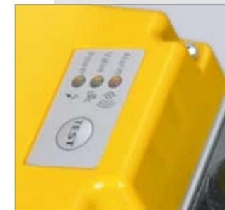
Bei einer Störung (z. B. verstopfte Ablaufleitung), wird nach 60 Sekunden der Alarmmodus ausgelöst, in dem der ECO DRAIN weiterarbeitet. Eine blinkende LED weist auf die Störung hin. Über einen potential freien Kontakt lässt sich die Störmeldung an Leittechnik oder Kompressorsteuerung weiterleiten (ab ECO DRAIN 31).
